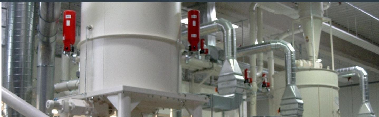
Processos complexos exigem tecnologias avançadas para proteção de pessoas e equipamentos. Os sistemas de supressão ATEX são formados por sensores de pressão, painel de comando e garrafas supressoras de explosão.
